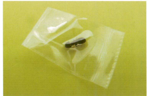
方法1：セロテープで周囲を囲むように接着する
